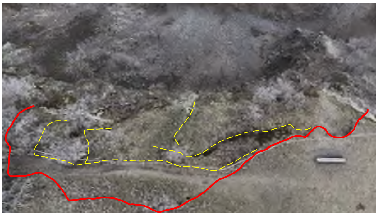
Obrázek 7: horní pohled na odtrhovou zónu nestabilního masivu PP Zámky, červená linie vymezuje úplný rozsah hlavní odtrhové linie, žluté linie jsou výchozy podružných zlomových a odtrhových struktur masivu s významnými poklesy
